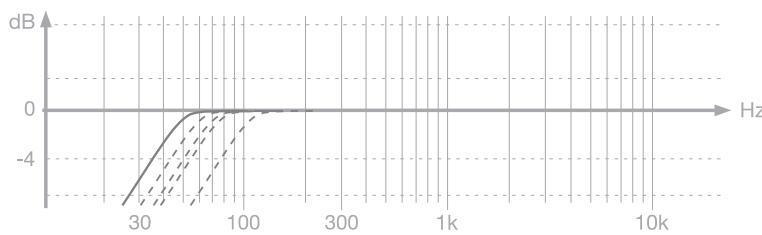
設定は、ボタンを押すごとに変わります。印字されていない設定(35Hz、65Hz)は、2つのLEDが同時に点灯します(35Hz:FULLと50Hzが点灯、65Hz:50Hzと80Hzが点灯)。
